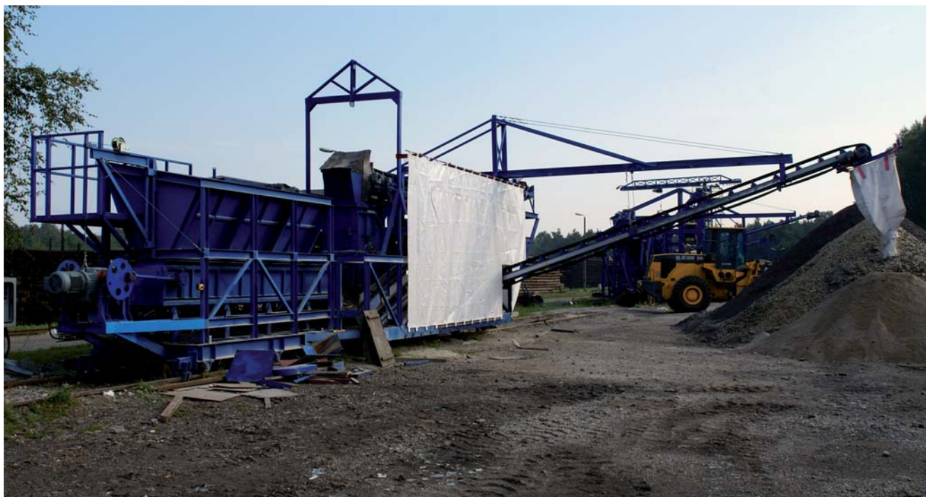
Maszyna do otrzymywania mączki szklanej. Z jednej strony wysypuje się dowolny złom szklany, a z drugiej wychodzi piasek 0 do 2 mm
